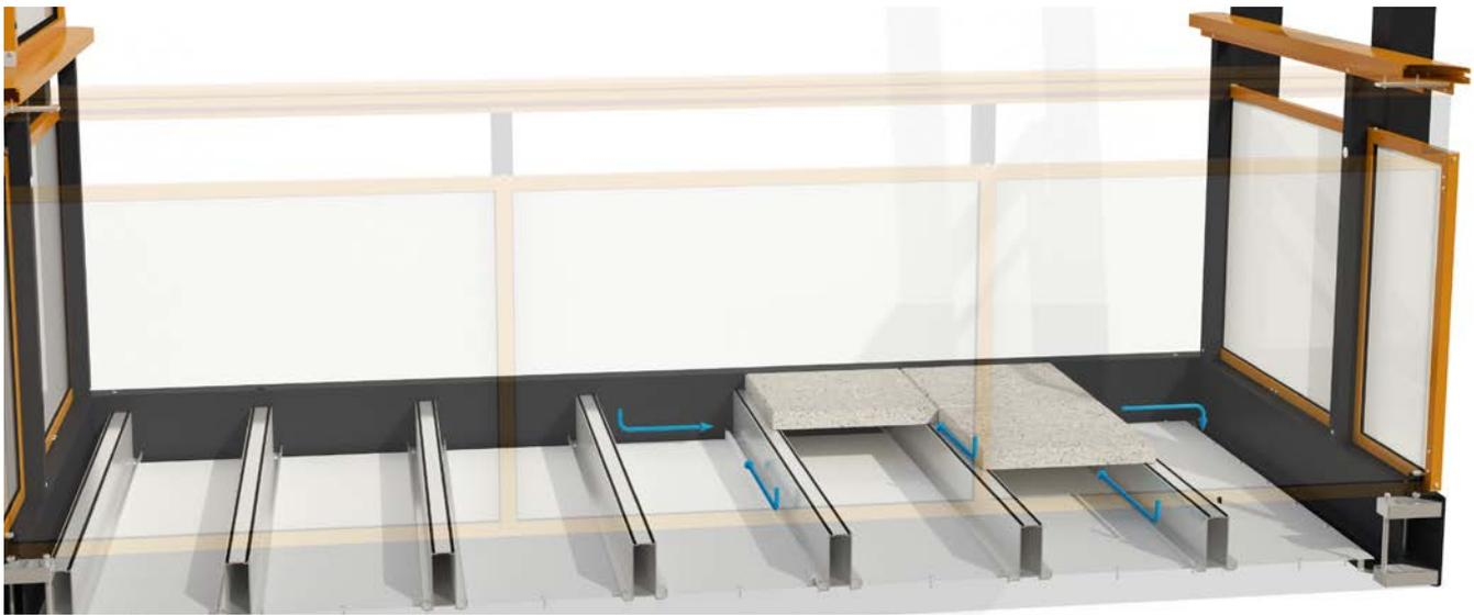
*Entwässerung – folgen Sie den Pfeilen, um zu sehen, wie das Wasser auf den Boden geleitet wird.*
